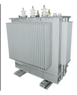
Трансформаторы силовые трехфазные двухобмоточные с естественным охлаждением масла. Трансформаторы этого типа выполнены в герметичном исполнении с полным заполнением маслом под вакуумом. Температурные изменения масла компенсируются изменением объёма гофрированных стенок бака за счёт их пластичной деформации. Преимуществом герметичных трансформаторов является то, что масло не имеет непосредственного контакта с атмосферой, исключая попадание влаги из окружающей среды.
